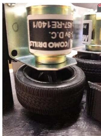
Coller la « Barre\_reglage\_moteurs » au « Support\_moteurs » avec de la colle forte. Selon la taille de vos supports de moteurs, vous pouvez positionner la barre dans un sens ou dans l'autre. Les roues doivent ne pas toucher le support mais être assez basses pour pouvoir attraper et propulser la bille. En utilisant des vis et des écrous, positionner les supports de moteur dans la barre de réglage.
