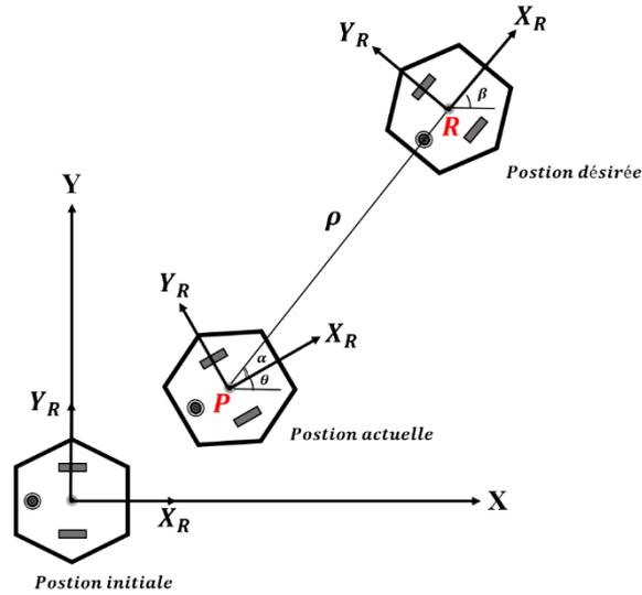
Le système de coordonnées du robot est régi par l'action combinée de deux vitesses linéaire et angulaire. La cartésien de robot est donnée par :
